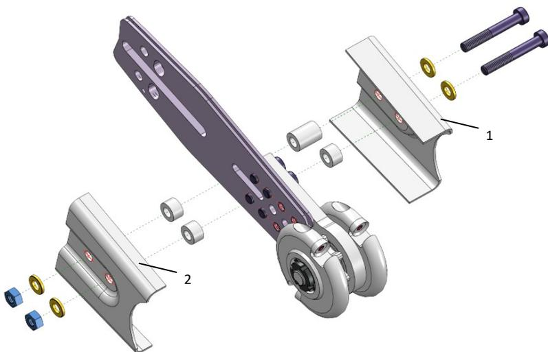
**8. ábra:** A védőlemezek felszerelése
