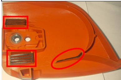
Abb. 2: mögliche Bereiche, die am Kettenraddeckel frei zu machen sind
