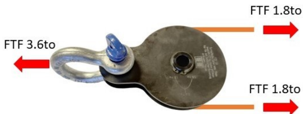
Obr. 7: Síly působící na jednoduchou vratnou kladku
