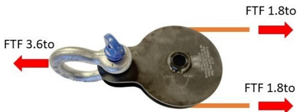
Bild 7: Krafter som verkar på en enkel omlänkingsrulle
