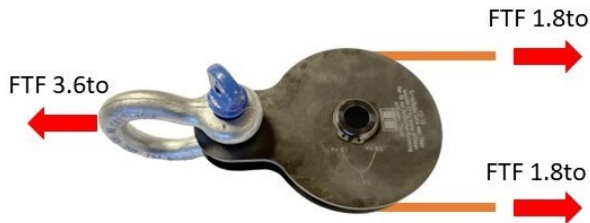
Abb.7: wirkende Kräfte an 1-fach Umlenkrolle
