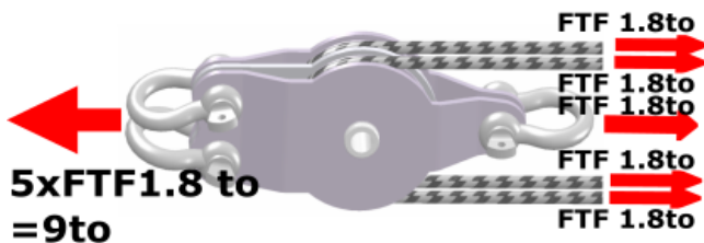
Fig. 2: forces agissant sur une poulie de renvoi double
