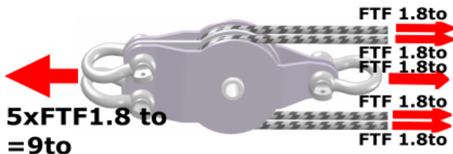
Bild 2: Krafter som verkar på en dubbel omlänkingsrulle
