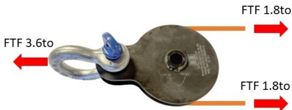
Obr. 7: Sily pôsobiace na jednoduchú vodiacu kladku
