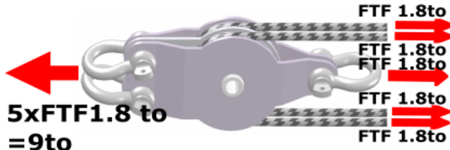
Abb. 2: wirkende Kräfte an 2-fach Umlenkrolle
