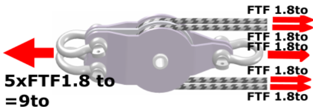
Rys. 2: Siły oddziałujące w przypadku podwójnego krążka kierunkowego
