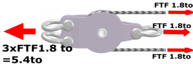
Abb. 1: wirkende Kräfte an 1-fach Umlenkrolle
