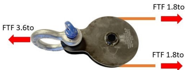
Rys. 7: Siły oddziałujące w przypadku pojedynczego krążka kierunkowego
