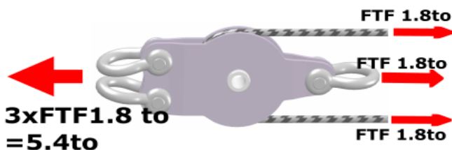
Rys. 1: Siły oddziałujące w przypadku pojedynczego krążka kierunkowego
