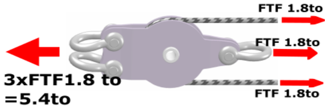
Fig. 1: Virkende krefter på enkel omløpstrinse
