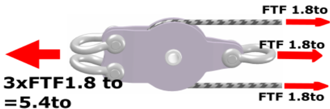
Obr. 1: Síly působící na jednoduchou vratnou kladku
