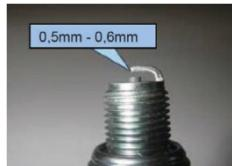
Controle la bujía de encendido como mínimo cada 50 horas de servicio. Preste atención a la distancia de los electrodos. La distancia de los electrodos debe ser de 0,5–0,6 mm.
