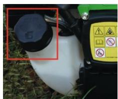
› Desenrosque lentamente la tapa del depósito para que pueda salir una posible sobrepresión.
