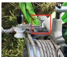
reducida presión del aire, podrá arrancar el motor en la posición de medio gas. Si arranca el motor en posición de medio gas, el cabrestante de arrastre dará un poco de gas ya al arrancar.
