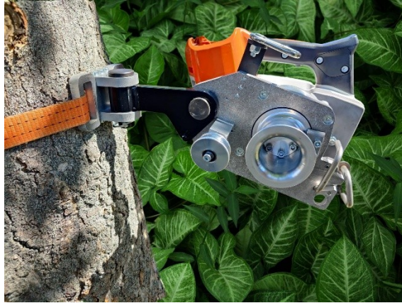
Abbildung 4: Montage der Anschlaghilfe
