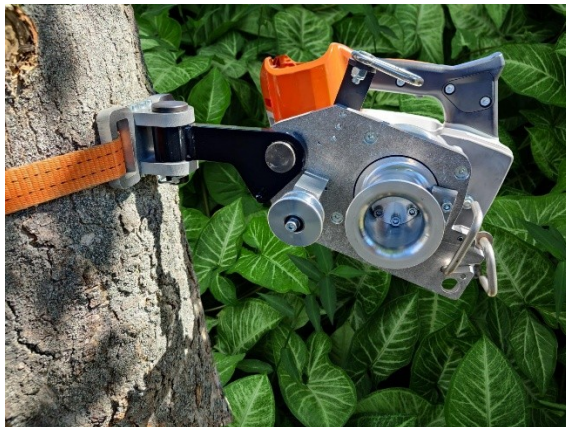
Fig 14: Montering av stoppanordningen
