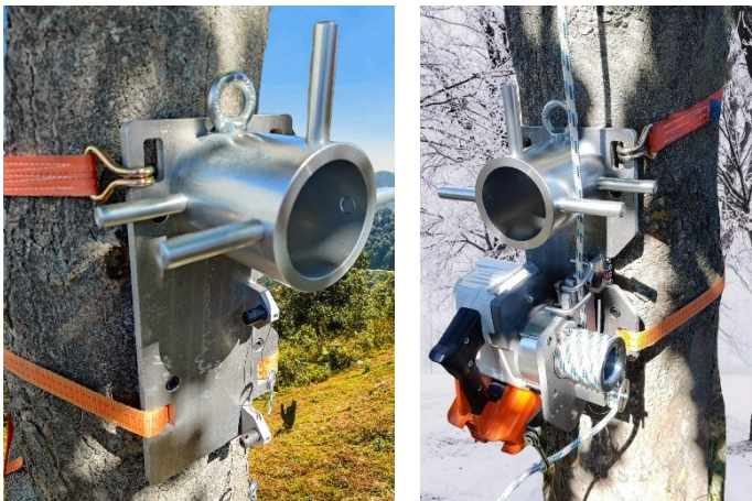
Fig. 11: Montering av riggplattan
