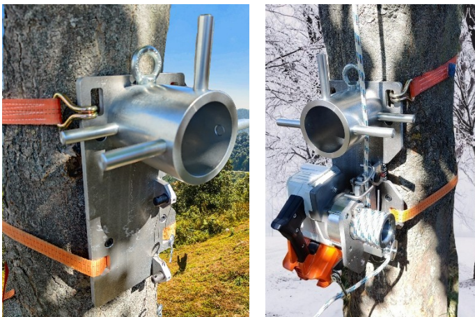
Fig. 11: Montering av riggplattan
