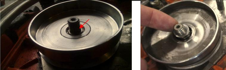
Die mitgelieferten Unterlegscheibe(n) nach dem Aufsetzen der Kupplungsglocke auf den Wellenabsatz legen
