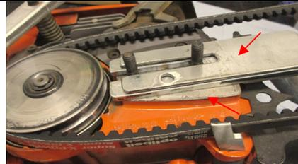
Demontage des Ölleitblechs; Ab BJ 11/13 muss ein zusätzliches Abstandsblech verwendet werden
