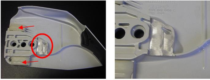
Kettenraddeckel im markierten Bereich frei schleifen und Gleitleisten entfernen
