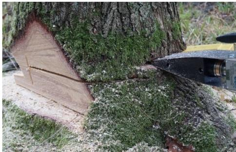
Das Anlegen des versetzten Fällschnitts ist verpflichtend, da dieser die gefährliche Berührung zwischen dem Titan 80 Pro und der Motorsägenkette vermeidet.
