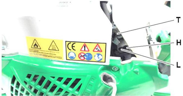
Fig. 20 : Vis de réglage du carburateur sur l'appareil portatif motorisé
