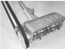
**Champ d'application :** Cet appareil permet de réaliser des rainures dans l'écorce des arbres pour priver les scolytes de leur habitat naturel. La résine coule des rainures et durcit en surface. Cela entrave le développement des larves de scolytes. De plus, la décomposition du tronc d'arbre éraflé est favorisée, car il sèche moins vite qu'après l'écorçage. Aussi, les spores fongiques et les microbes trouvent une grande surface d'attaque dans les fissures.
