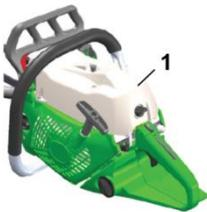
À des températures inférieures à +10°C, vous pouvez optimiser les performances du carburateur en mélangeant l'air froid à l'air chaud du cylindre. Pour ce faire, il faut ouvrir le couvercle rotatif sous le filtre à air.
