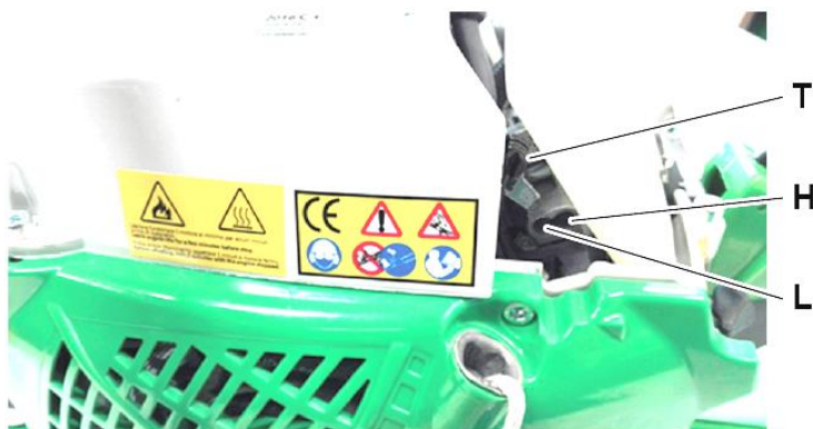
Fig. 20: Forgasserens innstillingsskruer på den motoriserte håndenheten
