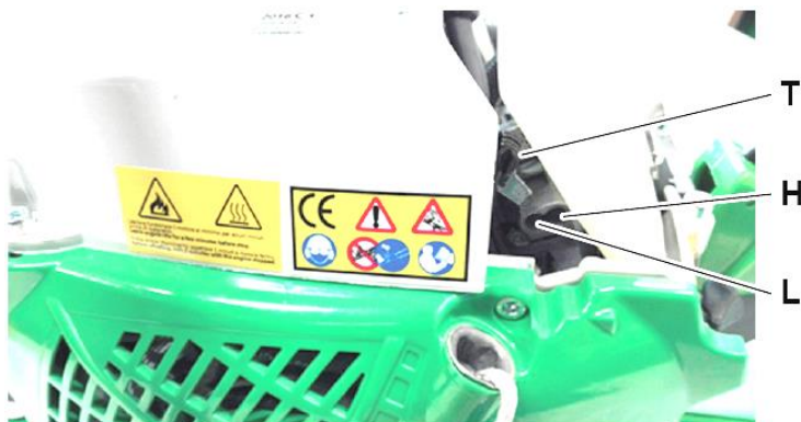
Bild 20: Förgasarens inställningsskruvar på den motoriserade handenheten.
