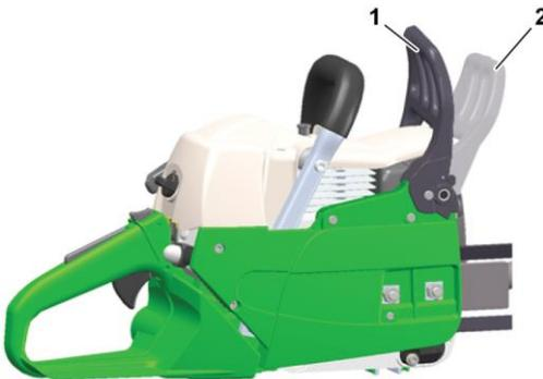
**Abb. 8:** Keilriemenbremse einrücken
