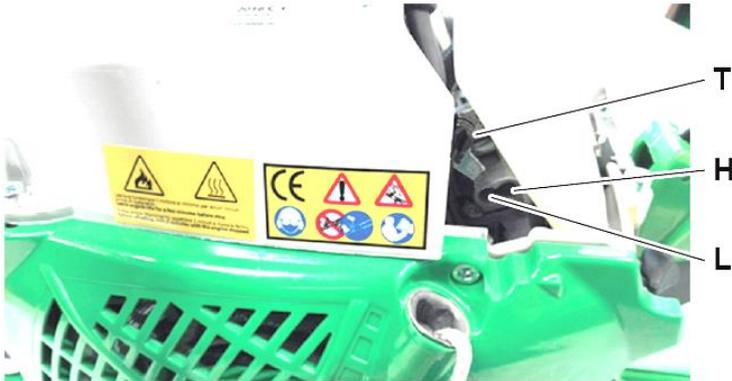
**Abb. 20:** Stellschrauben des Vergasers am motorisierten Handgerät
