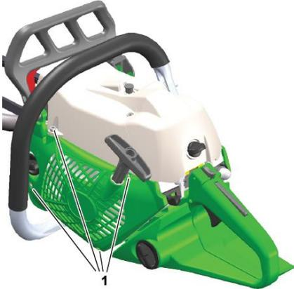
**Abb. 22:** Schrauben am Gebläsegehäuse
