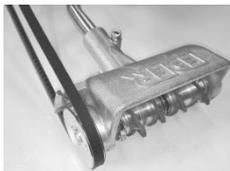
**Einsatzgebiet:** Das Gerät eignet sich zum Durchritzen der Baumrinde um der Borkenkäferbrut die Fressgänge zu blockieren. An den angeritzten Flächen blutet Harz aus und erhärtet an der Oberfläche. Dadurch werden die Maden der Borkenkäfer in Ihrer Entwicklung behindert. Weiterhin wird der Zerfall des geritzten Baumstammes gefördert, weil er weniger schnell austrocknet als nach der Entrindung. Außerdem finden Pilzsporen und Mikroben reichlich Angriffsfläche in den Ritzen.
