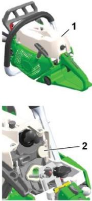
Bei Temperaturen unter +10 °C können Sie die Vergaserleistung optimieren, indem Sie die kalte mit der warmen Luft aus dem Zylinder mischen. Dazu müssen Sie den Drehdeckel unter dem Luftfilter öffnen.
