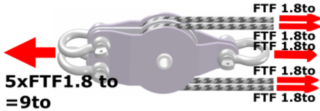
Abbildung 2: wirkende Kräfte an 2-fach Umlenkrolle
