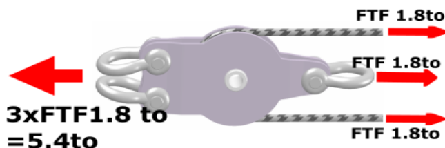
Abbildung 1: wirkende Kräfte an 1-fach Umlenkrolle
