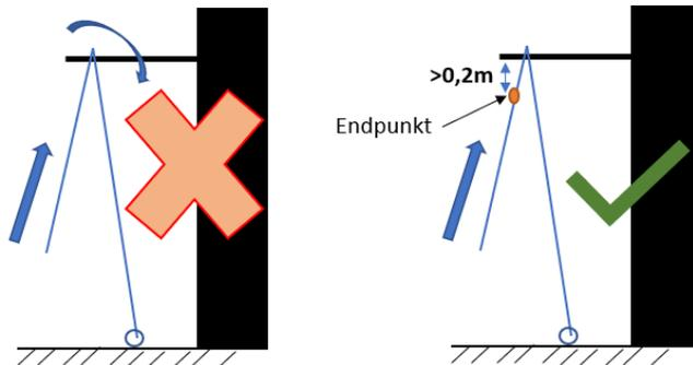
Prüfen Sie vor jeder Anwendung die Funktion der Bremse durch hoch und wieder runter fahren von einem Meter.
