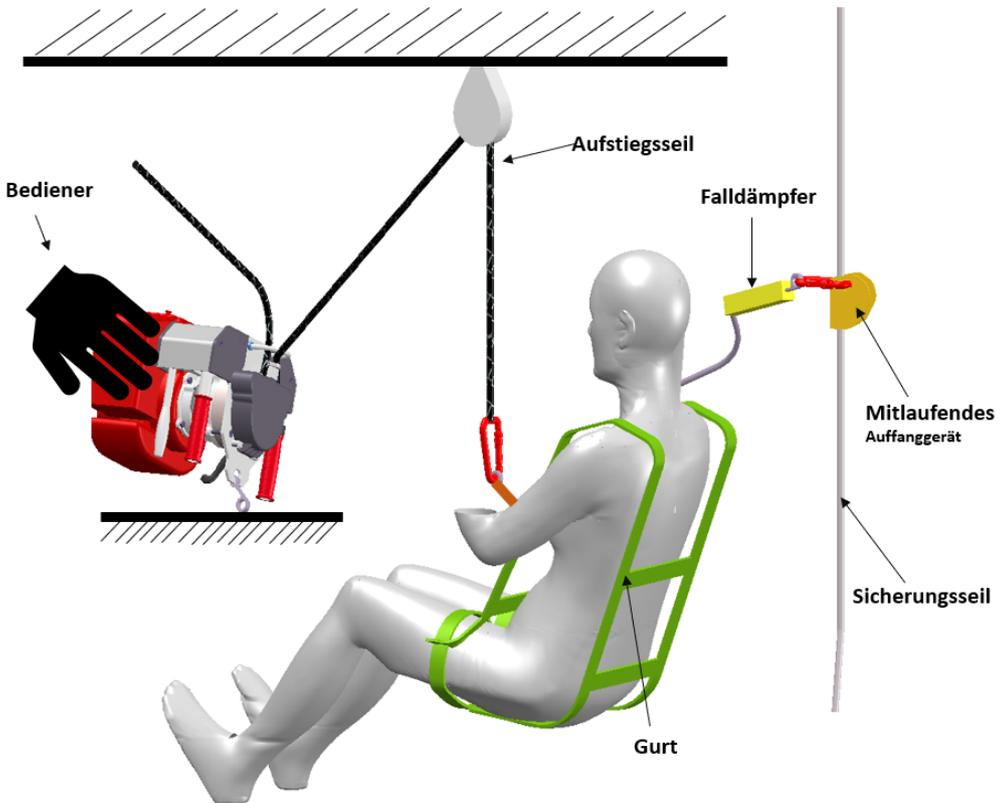
Sicherungsseil nach EN 1891 Typ A – Beachten Sie die Bedienungsanleitung des mitlaufenden Auffängergerätes und das zulässige Maximalgewicht des verwendeten Falldämpfers.
