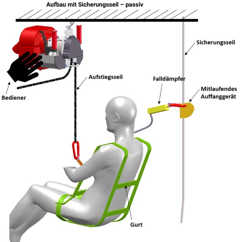
Sicherungsseil nach EN 1891 Typ A – Beachten Sie die Bedienungsanleitung des mitlaufenden Auffanggerätes und das zulässige Maximalgewicht des verwendeten Falldämpfers.
