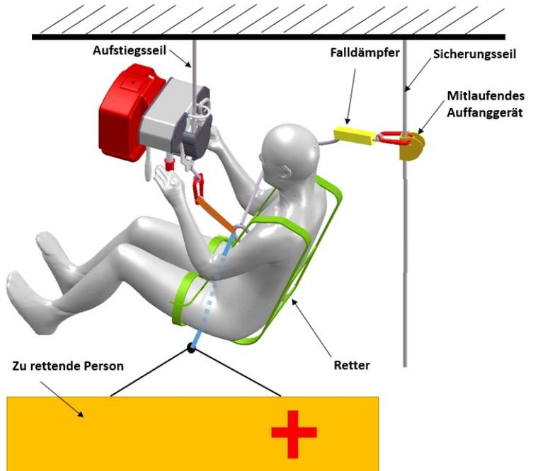
Sicherungsseil nach EN 1891 Typ A – Beachten Sie die Bedienungsanleitung des mitlaufenden Auffanggerätes und des Falldämpfers, sowie das jeweils zulässige Maximalgewicht.
