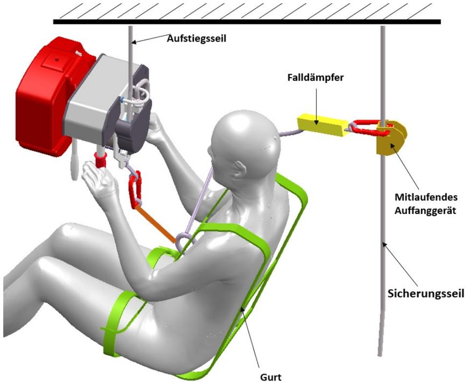
Sicherungsseil nach EN 1891 Typ A – Beachten Sie die Bedienungsanleitung des mitlaufenden Auffanggerätes und das zulässige Maximalgewicht des verwendeten Falldämpfers.
