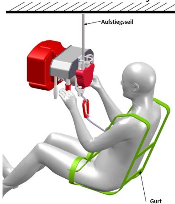
Das Einseilsystem ist ausschließlich im Bereich SKT d.h. in Situationen zugelassen, die sich auf Nummer 3.4.2 der Betriebssicherheitsverordnung berufen (z.B. beim Baumklettern). Das maximal zulässige Gewicht beim Einseilsystem beträgt 130kg.
