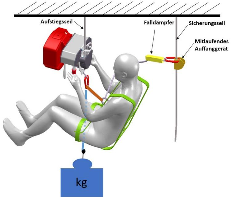
Sicherungsseil nach EN 1891 Typ A – Beachten Sie die Bedienungsanleitung des mitlaufenden Auffanggerätes und das zulässige Maximalgewicht des verwendeten Falldämpfers.
