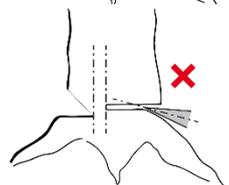
Conséquence : Le coin de levage et la vis reçoivent une charge oblique. Endommagement de la vis, de l'écrou d'entraînement et du coin de levage.
