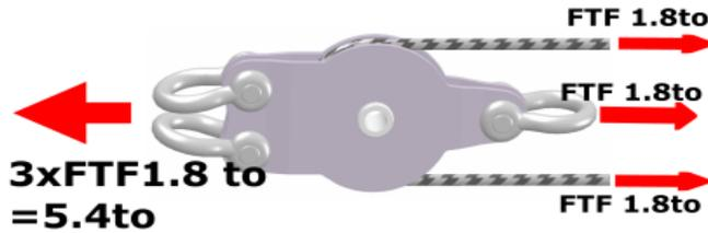
Abb. 1: wirkende Kräfte an 1-fach Umlenkrolle
