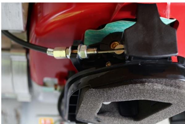
Fig. 12: Réglage du câble Bowden
