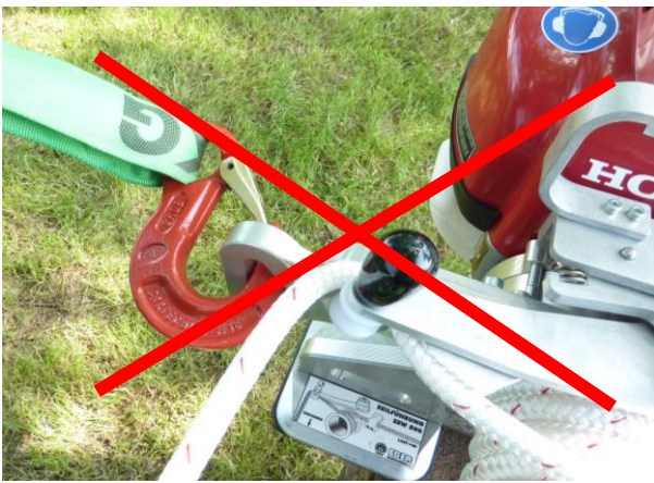
Fig. 6: Fixation incorrecte du Powerwinch 500 EDER
