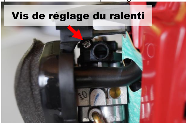
Fig. 11: Réglage du ralenti
