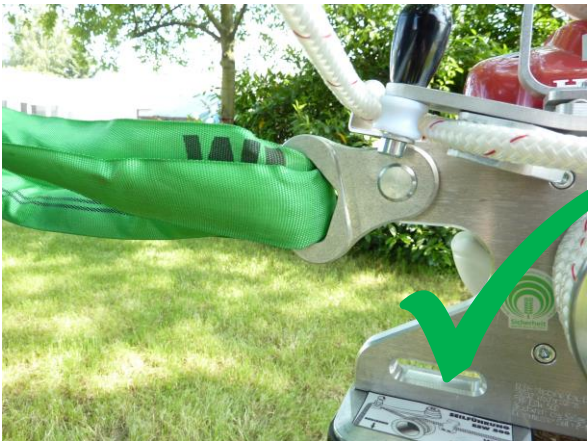
Fig. 7 Fixation correcte du Powerwinch 500 EDER
