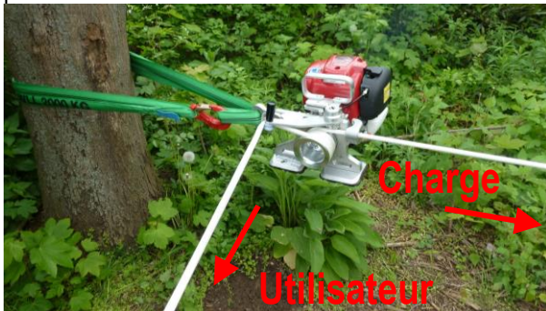
Fig. 4: Le Powerwinch 500 EDER en position de travail
