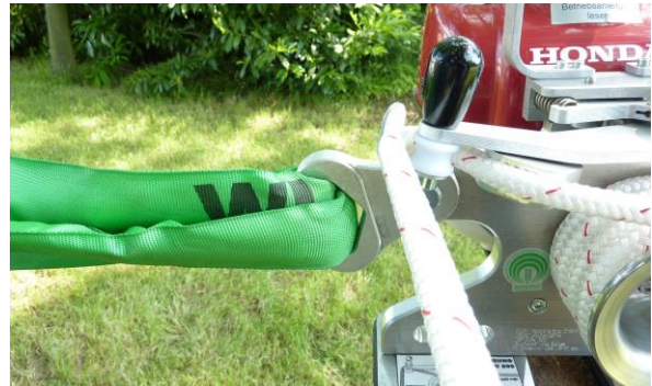
Fig. 5: Passage de la corde par le serre-corde
