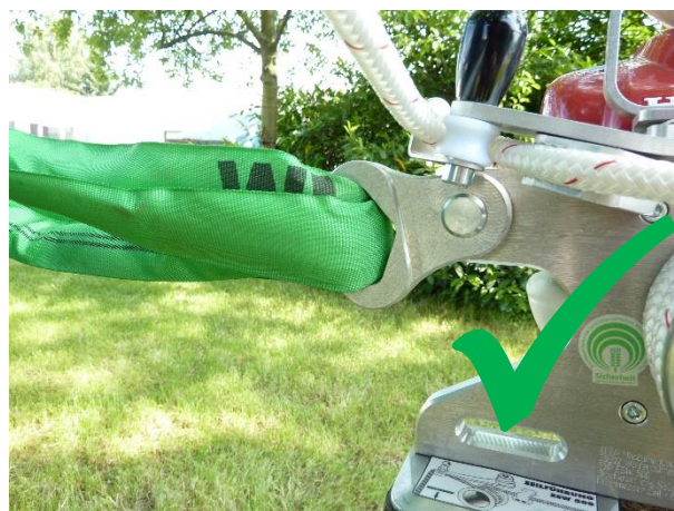
Fig. 7: Riktig festing av EDER Powerwinch
