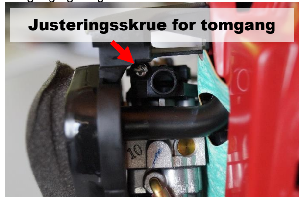
Fig. 11: Justering av tomgang
