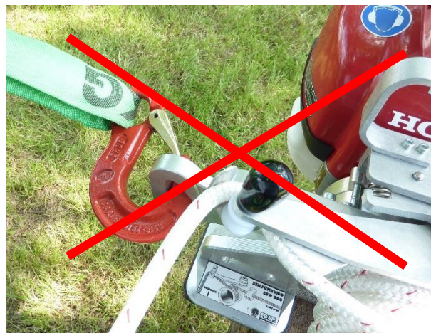
Fig. 6: Feil festing av EDER Powerwinch
