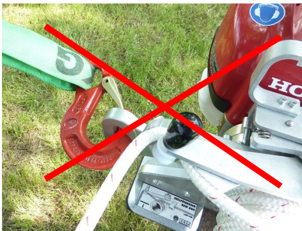
Bild 6: Felaktig fastsättning av EDER Powerwinch
