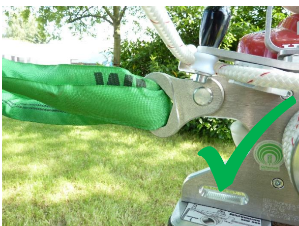
Bild 7: Rätt fastsättning av EDER Powerwinch
