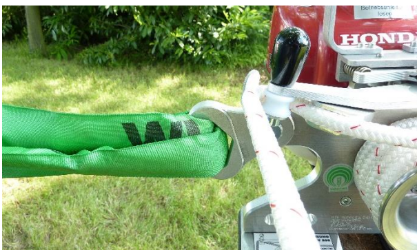
Bild 5: Repstyrning genom replämman
