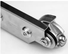
**Aufbau:** Die Scheibenfräse ESF verwendet eine zu der gewählten Motorsäge passende Kupplungsglocke, die an Stelle des Kettenritzels montiert wird. Die Scheibenfräse ist an ein Schwert montiert und wird anstelle des Kettensägenschwertes an der Motorsäge verwendet.
