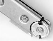
**Aufbau:** Der Troghöhler ETH verwendet eine zu der gewählten Motorsäge passende Kupplungsglocke, die an Stelle des Kettenritzels montiert wird. Der Troghöhler ist an ein Schwert montiert und wird anstelle des Kettensägenschwertes an der Motorsäge verwendet.
