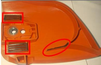
Abb. 2: mögliche Bereiche, die am Kettenraddeckel frei zu machen sind
