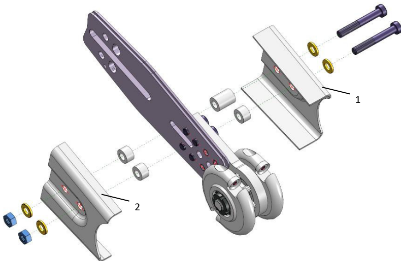
Obr. 2. Montáž ochranných plechov
