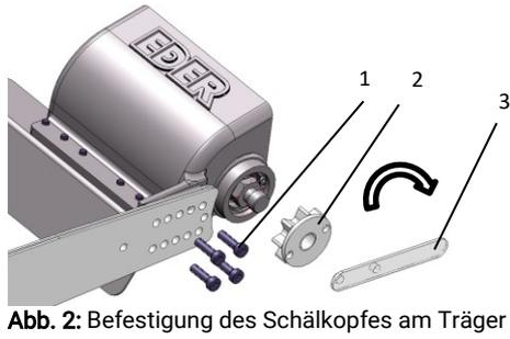
**Abb. 2:** Befestigung des Schälkopfes am Träger
