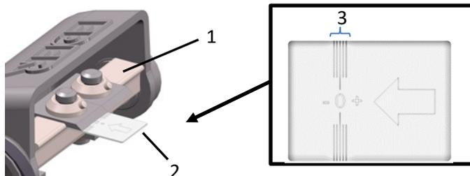
**Obr. 9:** Nastavení nožů
