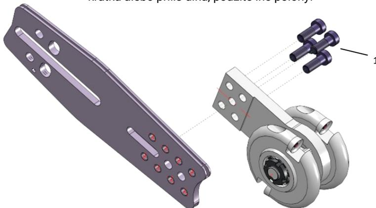
**Obr. 7.** Montáž nadstavca na frézovanie ETH-C-Mini
