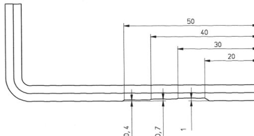
**Fig. 10** : Clé Allen avec encoches
