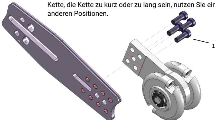
**Abb.7.** Montage des Troghöhlners ETH-C-Mini
