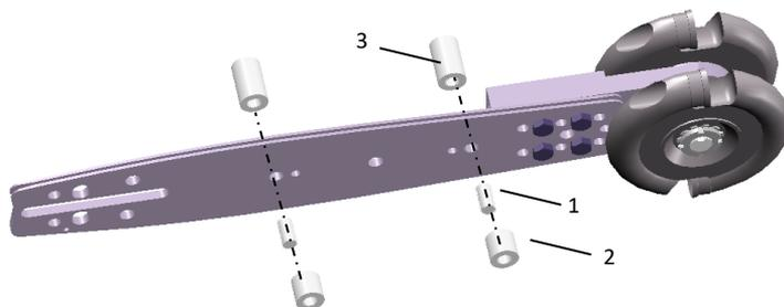
**Fig. 5:** Montage de la tôle de protection
