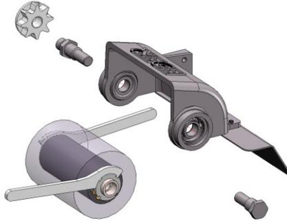
**Fig. 15 :** Remplacement de la brosse rotative
