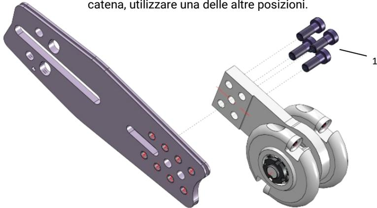
**Fig. 7.** Montaggio del parafango ETH-C-Mini
