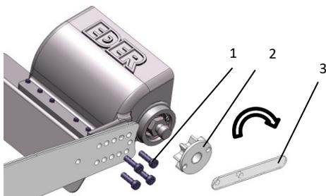
Obr. 2: Upevnenie lúpacej hlavy na držiak
