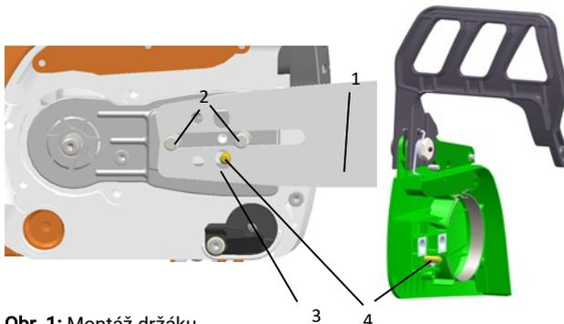
Obr. 1: Montáž držáku
