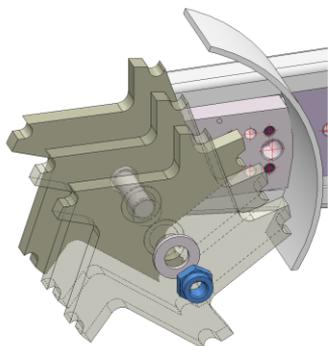
**Obr. 14:** Výmena nožov na drážkovacej fréze
