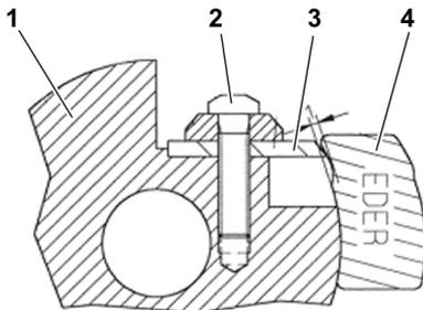
**Obr. 17:** Výměna nožů na kotoučové fréze
