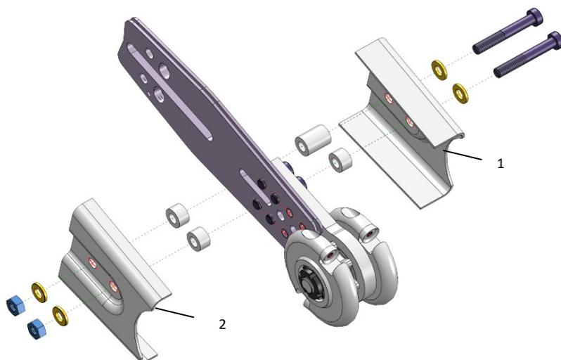
**Fig. 8.** Montaggio delle piastre di protezione
