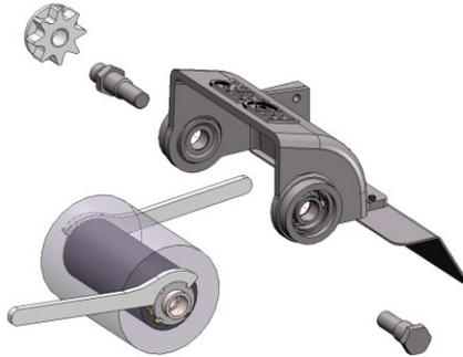
**Fig. 15:** Cambio della spazzola rotante
