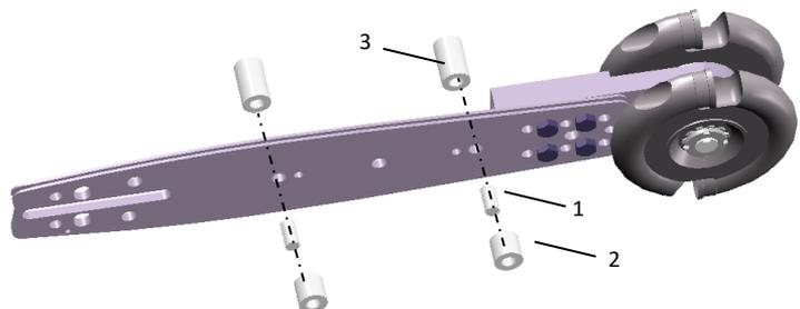
**Abb. 5:** Montage Schutzblech
