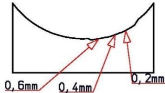
**Fig. 12:** Taglio di profondità sul calibro del coltello
