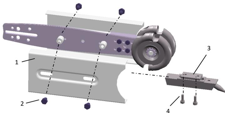
**Obr. 6.:** Montáž ochranného plechu a vodiaceho trňa
