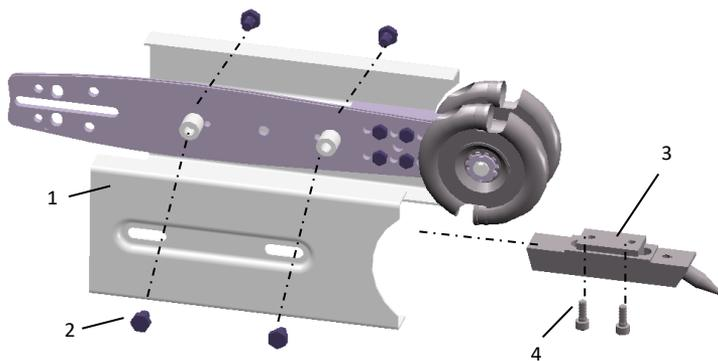
**Obr. 6.: Montáž ochranného plechu a vodícího trnu**
