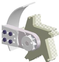
Si possono montare fino a tre dischi taglienti sul supporto, producendo una superficie liscia senza vibrazioni.
