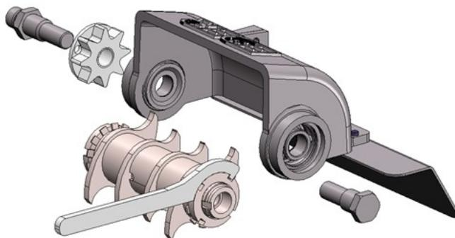
Obr. 16: Výměna nožů
