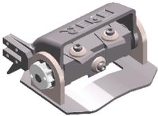
**Conception :** Le rabot rond ERH-C est monté sur un guide-chaîne adapté à la tronçonneuse, il est entraîné par une chaîne comme la lame d'une tronçonneuse normale. Aucune modification n'est nécessaire sur la tronçonneuse.
