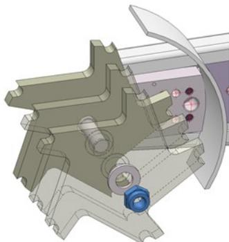
**Obr. 14:** Výměna nožů na žlábkové fréze
