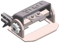
**Conception :** Le rabot plat EPH-C est monté sur un guide-chaîne adapté à la tronçonneuse et est entraîné par une chaîne comme la lame d'une tronçonneuse normale. Aucune modification n'est nécessaire sur la tronçonneuse.
