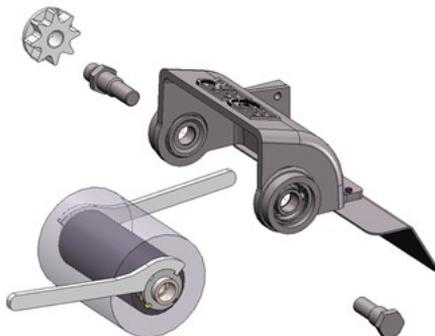
**Obr. 15:** Výměna kulatého kartáče
