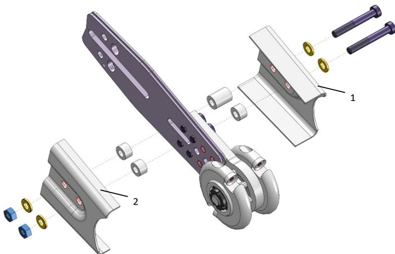
**8. ábra:** A védőlemezek felszerelése
