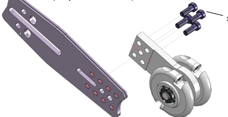
**Obr. 7.** Montáž nástroje na hloubení žlabů ETH-C-Mini
