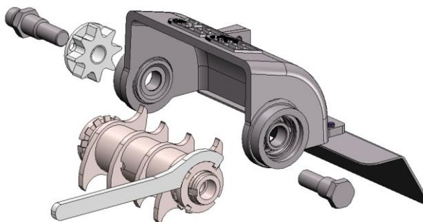
Fig. 16 : Remplacement des couteaux
