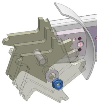
**Fig. 14:** Remplacement des couteaux sur la fraiseuse rainureuse
