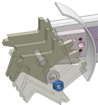
**Fig. 14:** Cambio dei coltelli sulla fresatrice scanalatrice
