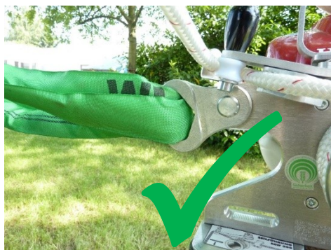
Bild 7: Rätt fastsättning av EDER WINCH
