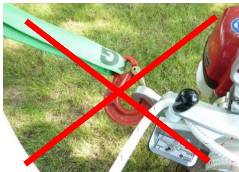
Rys.6: Niewłaściwe mocowanie wyciągarki EDER WINCH
