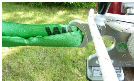
Obr.5: Vedení lana lanovou svorkou
