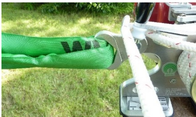
Fig. 5: Tauføring gjennom tauklemmene
