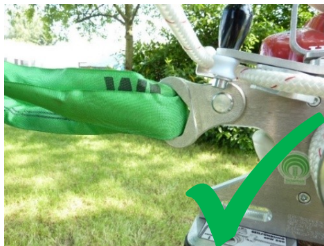
Obr.7: Správné upevnění navijáku EDER WINCH
