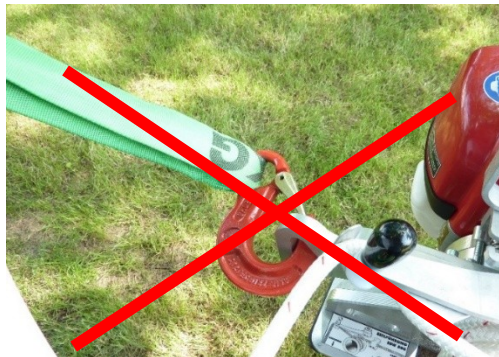
Obr.6: Nesprávné upevnění navijáku EDER WINCH
