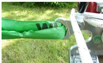
Fig. 5: Passage de la corde par le serre-corde
