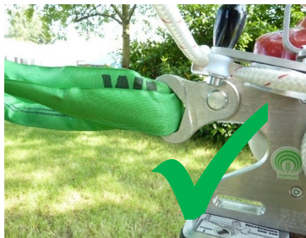
Fig. 7: Fixation correcte du WINCH 500 EDER
