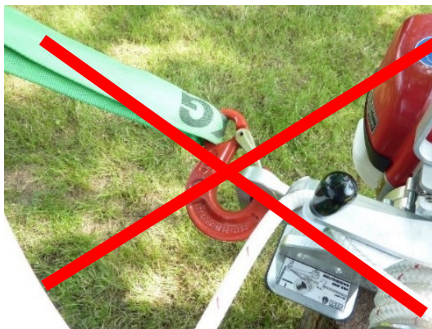
Fig. 6: Feil festing av EDER WINCH
