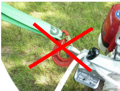
Abb. 6: Falsche Befestigung der EDER WINCH
