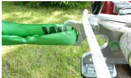
Rys.5: Prowadzenie liny przez zacisk linowy
