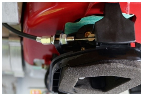
Rys.12: Ustawianie ciężna Bowdena
