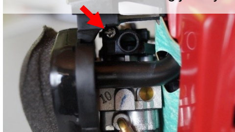
Rys.11: Ustawianie biegu jałowego
