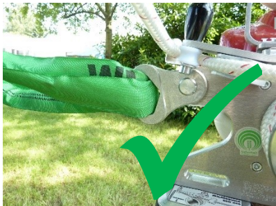
Obr.7: Správne upevnenie zariadenia EDER WINCH
