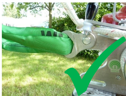
Rys.7: Prawidłowe mocowanie wyciągarki EDER WINCH
