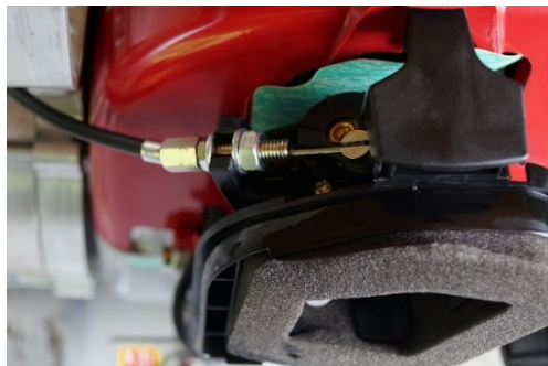
Fig. 12: Justering av Bowdenvaieren
