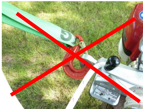
Bild 6: Felaktig fastsättning av EDER WINCH
