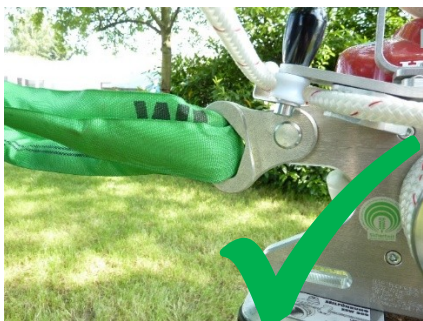
Abb. 7: Richtige Befestigung der EDER WINCH
