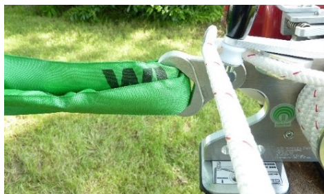
Bild 5: Repstyrning genom replämma
