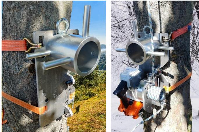
Abbildung 1: Montage der Rigging-Platte
