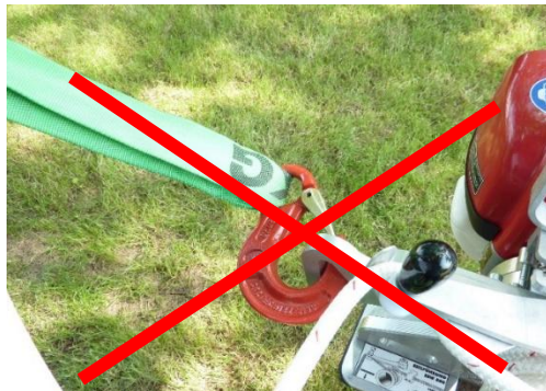
Obr.6: Nesprávné upevnění navijáku EDER WINCH
