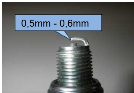
Obr.15: Vzdálenost elektrod
