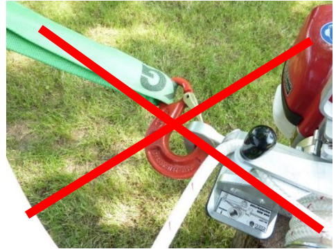
Bild 6: Felaktig fastsättning av EDER WINCH
