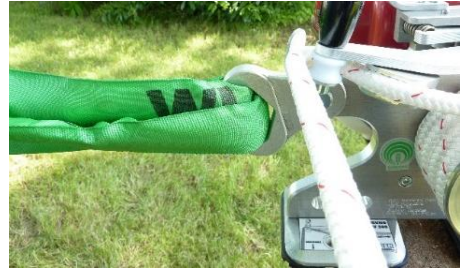
Rys.5: Prowadzenie liny przez zacisk linowy
