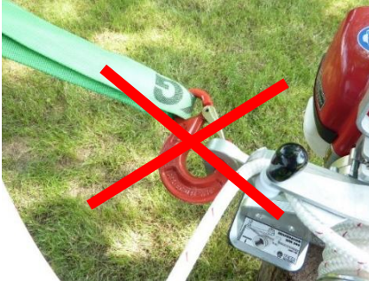
Abb. 6: Falsche Befestigung der EDER WINCH
