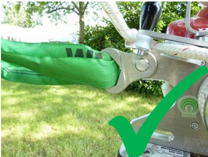
Abb. 7: Richtige Befestigung der EDER WINCH
