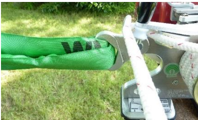
Fig. 5: Tauføring gjennom tauklemmene
