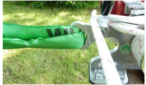
Bild 5: Repstyrning genom replämman
