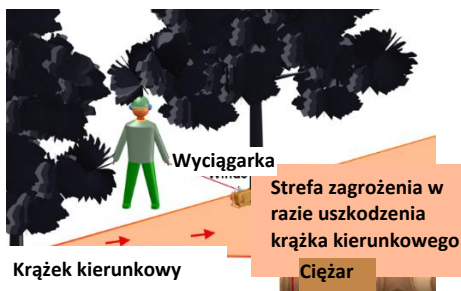
Rys.2: Strefa zagrożenia w przypadku usterki jednego z zastosowanych krążków
