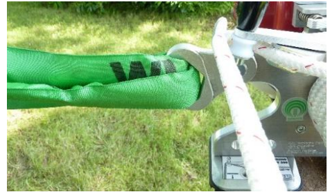
Obr.5: Vedení lana lanovou svorkou
