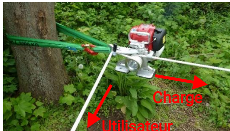
Fig. 4: Le WINCH 500 EDER en position de travail
