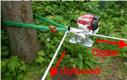
Rys.4: Wyciągarka EDER WINCH 500 w pozycji roboczej
