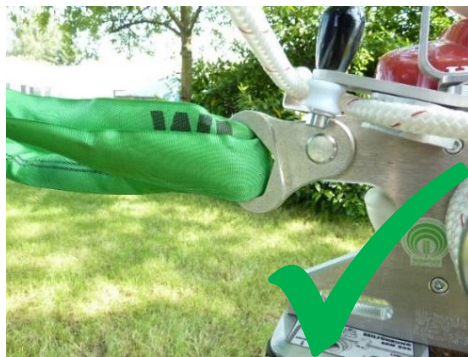
Obr.7: Správné upevnění navijáku EDER WINCH
