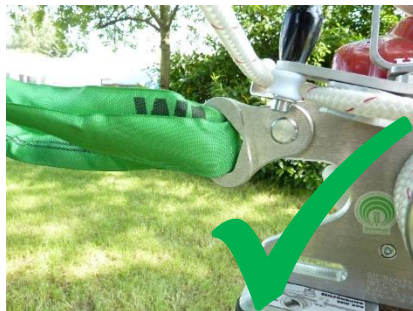
Rys.7: Prawidłowe mocowanie wyciągarki EDER WINCH
