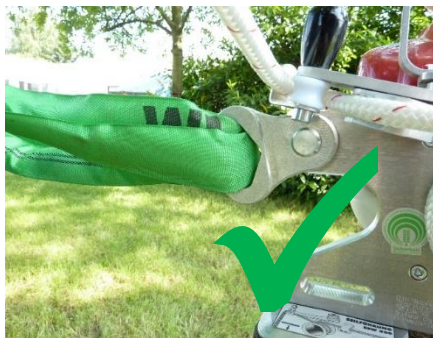
Fig. 7: Fixation correcte du WINCH 500 EDER
