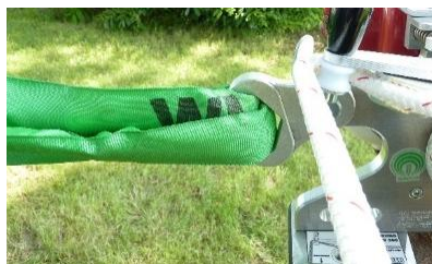
Fig. 5: Passage de la corde par le serre-corde
