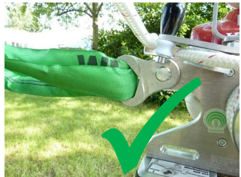
Bild 7: Rätt fastsättning av EDER WINCH
