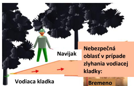
Obr.2: Nebezpečná oblasť v prípade zlyhania použitej vodiacej kladky
